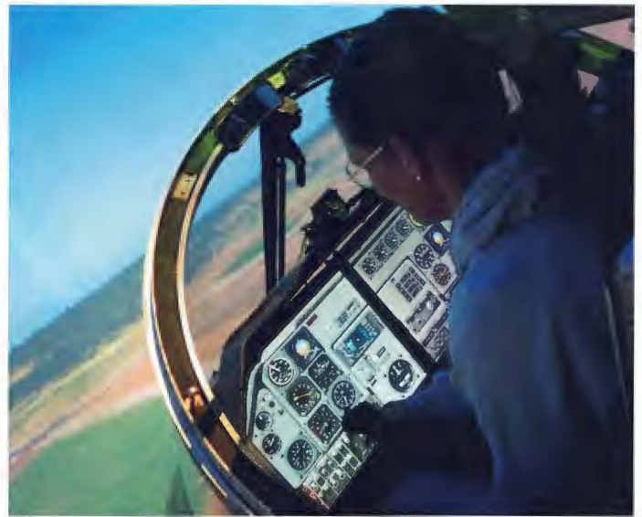
Simulatore till Flygvapnets SK 60 står i en stor dom med en filmprojicering på 240 grader. Simulatore är unik i sitt slag Sverige.
